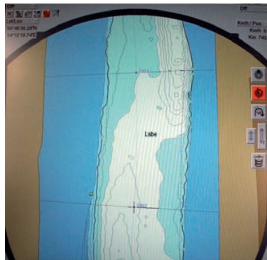
Abb. 4: Elektronische Binnengewässerkarten (IENC) zeigen die Wassertiefen in Abhängigkeit des aktuellen Pegelstands. Als Datengrundlage dienen die digitalen Geländemodelle aus der Fächerlotvermessung und die modellierten Pegelstände
